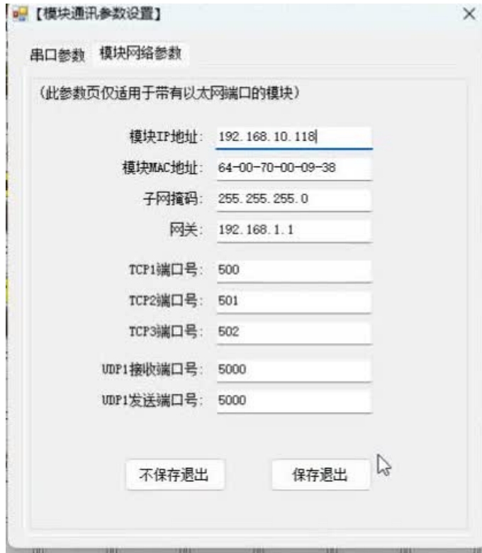
รูปที่ 2: หน้าต่าง 模块网络参数 — เปลี่ยน IP เป็น 192.168.10.118 แล้วกด 保存退出
